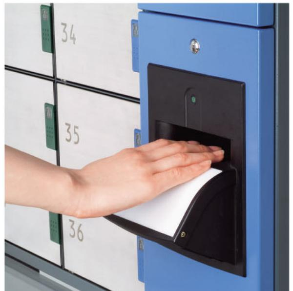
指の中にある真皮指紋を、爪側から透過させる光で読み取る、新しいバイオメトリクス認証方式です。指の内部組織を光学的に読み取るため、温度・湿度などの外部環境や、傷などの指の健康状態に影響されにくい認証が可能となりました。また、読み取り面に指を押し付ける必要がない非接触方式なので、清潔感を気にする方でも快適に操作できます。
