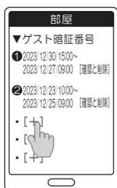
④[開始日時][終了日時][曜日指定][任意のゲスト暗証番号4~12桁]を入力して[発行]を押し、[通信接続待機中]表示後、玄関錠の[スタートボタン]を押します。ゲストにメールや電話で[ゲスト暗証番号]を伝えます。
